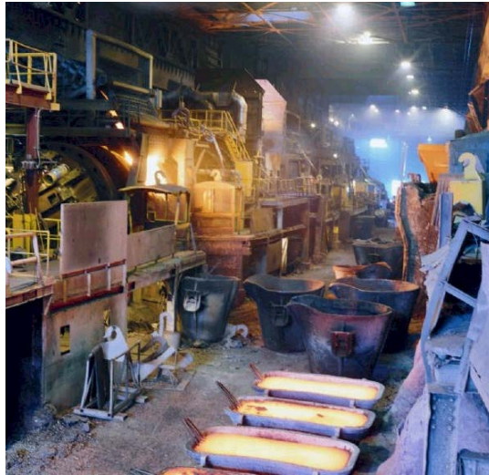
รูปที่ 5 เตา และแท่งโลหะทองแดง (copper anode) ที่ได้จากกระบวนการถลุง
