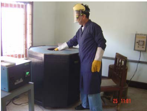
ถลุงเศษทองคำ - เงิน เปอร์เซนต์ต่ำด้วยเตาไฟฟ้า
