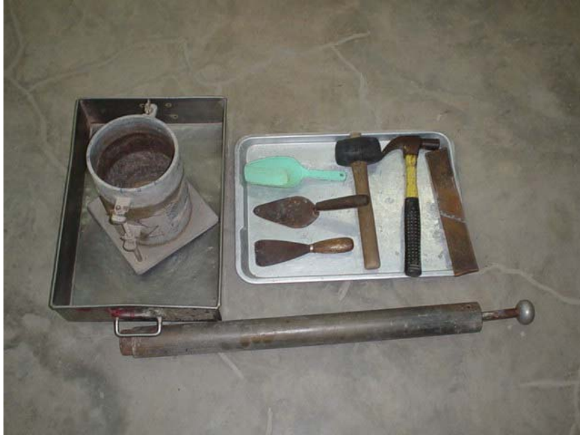
รูปที่ 2.10 แสดงอุปกรณ์บดอัดดิน
