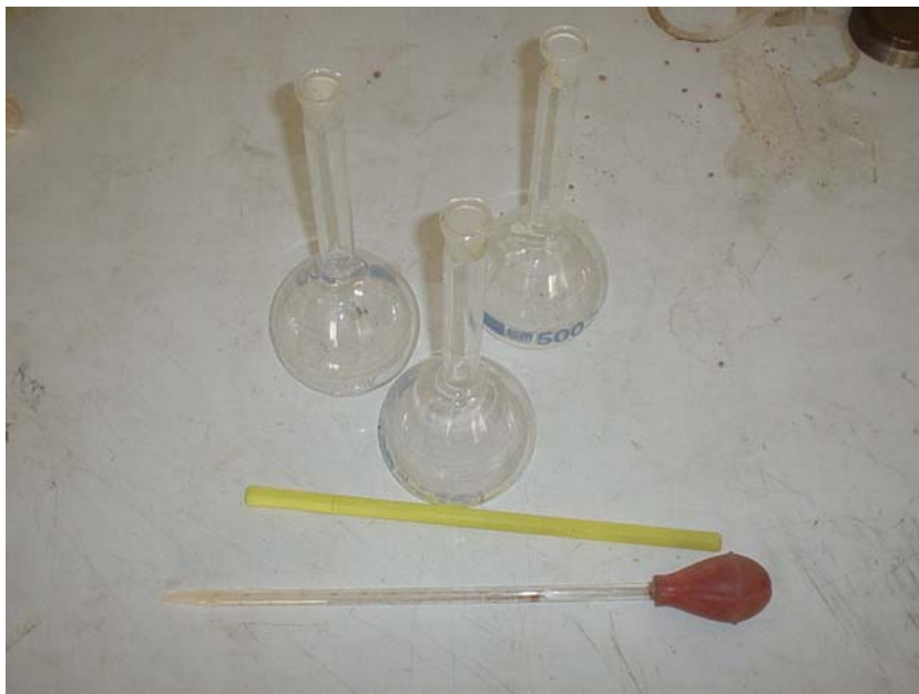
รูปที่ 2.9 แสดงอุปกรณ์ทดสอบความถ่วงจำเพาะ
