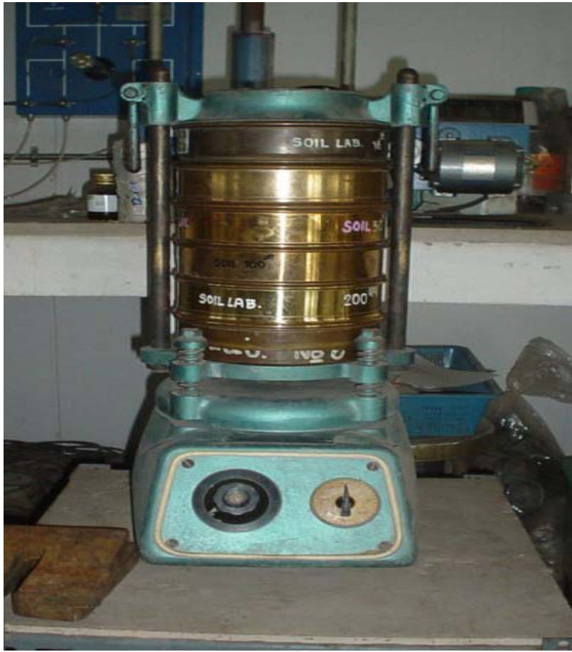
รูปที่ 2.6 แสดงชุดตะแกรงร่อนขนาดต่างๆ
