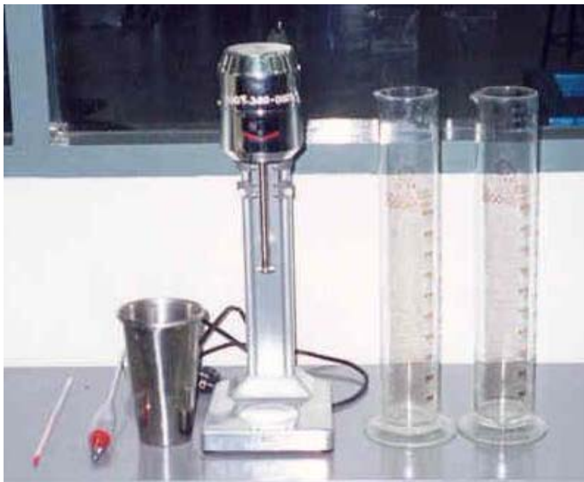
รูปที่ 2.8 แสดงอุปกรณ์ทดสอบไฮโดรมิเตอร์
