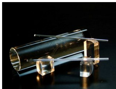
รูปที่ 3 ตัวอย่างผลิตภัณฑ์แก้วจากกระบวนการโซลเจล
