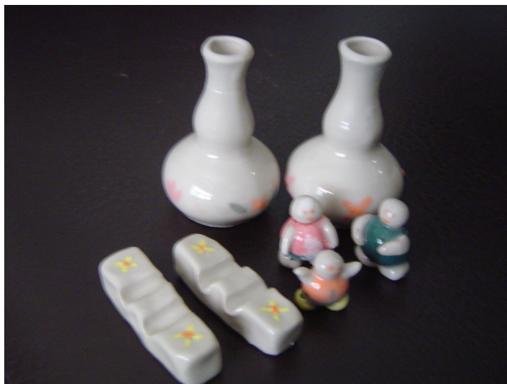
รูปที่ 4.6 แสดงชิ้นผลิตภัณฑ์ที่เตรียมจากสูตรที่ 8 เผาที่ 1200°C
