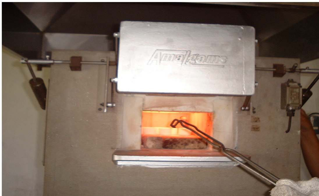
รูปที่ 5 การนำตัวอย่างที่ห่อตะกั่วแล้วใส่ในเบ้า cupel
