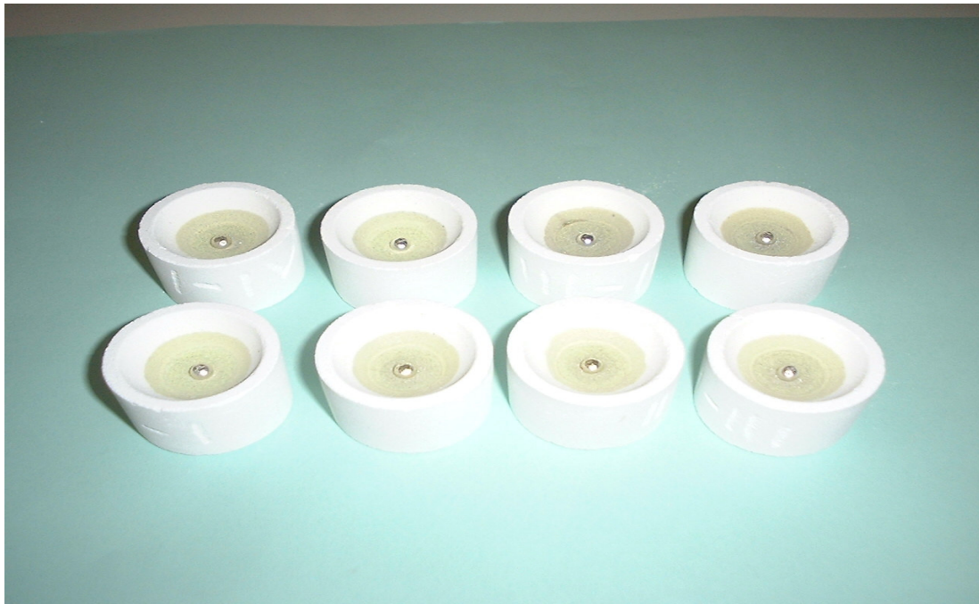
รูปที่ 6 แสดงเม็ดโลหะมีค่าที่อยู่ในเบ้า Cupel
