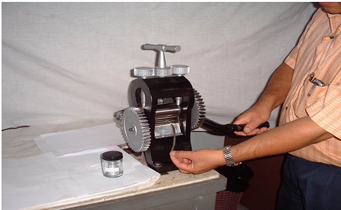
รูปที่ 7 แสดงการรีดตัวอย่างด้วยเครื่องรีดโลหะ
