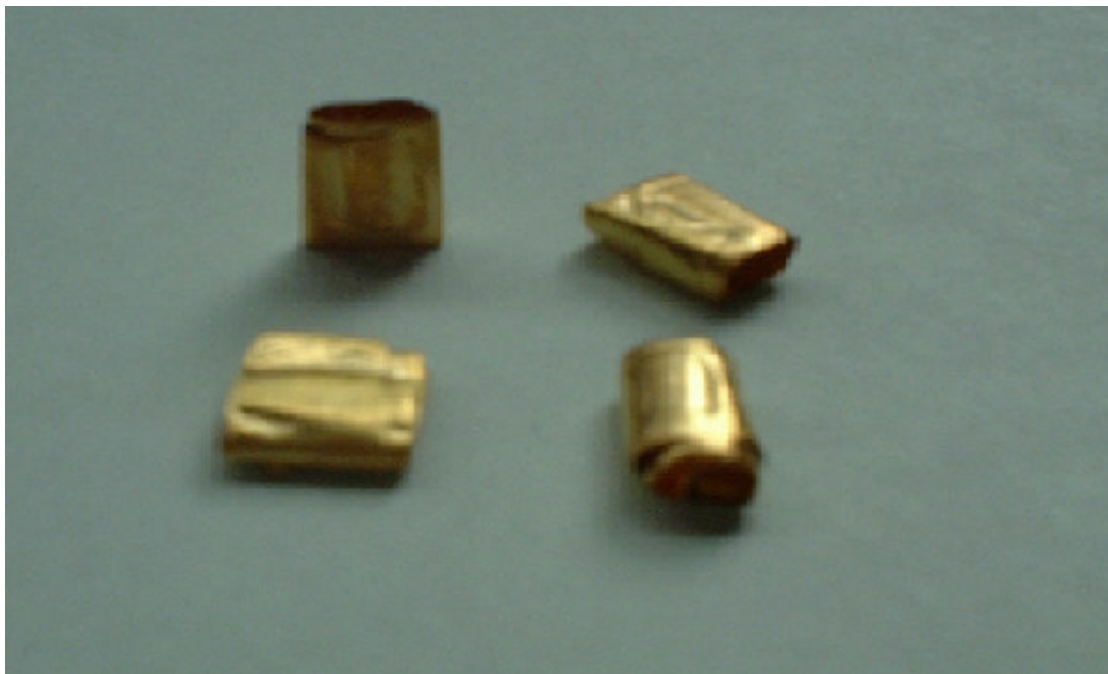
รูปที่ 9 ลักษณะแผ่นทองคำที่ anneal แล้ว
