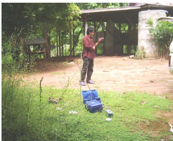
รูปที่ 4 การตรวจวัดแรงสั่นสะเทือนและแรงอัดอากาศบริเวณวัดถ้ำ
