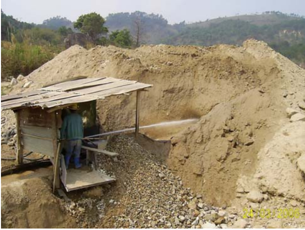
รูปที่ 2 การฉีดหินผุ-ดินทรายที่มีแร่ปะปนอยู่ให้แยกตัวอิสระจากกันและไหลเข้าสู่รางกึ่งแร่
