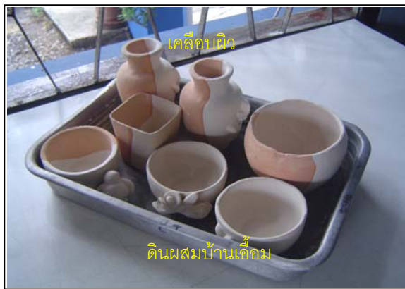
รูปที่ 4.11 แสดงชิ้นงานจากดินบ้านเอ่อมที่ผ่านการเผาดิบและเคลือบผิว
