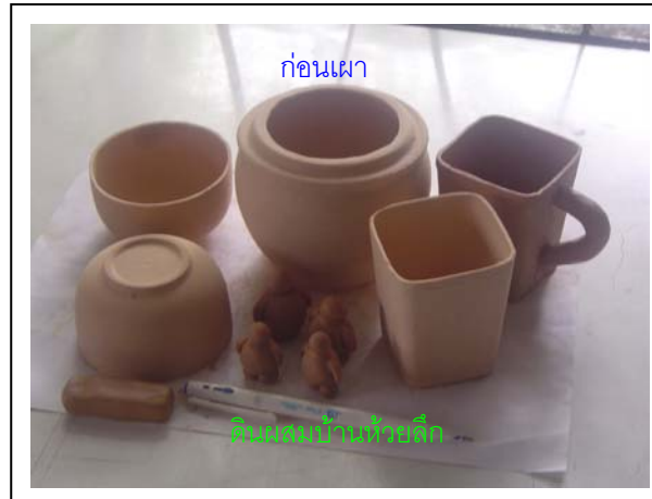
รูปที่ 4.6 แสดงชิ้นงานจากดินบ้านห้วยลึกที่ขึ้นรูปด้วยวิธีหล่อแบบและปั้นมือ
