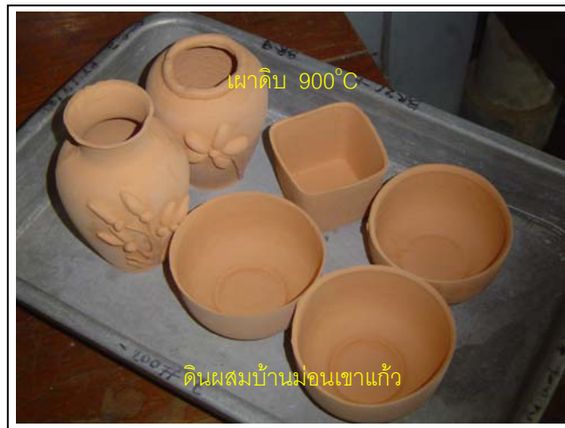
รูปที่ 4.3 แสดงชิ้นงานจากดินบ้านม่อนเขาแก้วที่ผ่านการเผาที่ 900°C
