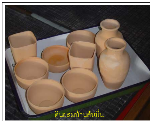
รูปที่ 4.21 แสดงชิ้นงานจากดินบ้านต้นมื่นที่ขึ้นรูปด้วยวิธีหล่อแบบและเผาดิบที่ 900°C
