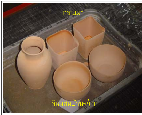
รูปที่ 4.18 แสดงชิ้นงานจากดินบ้านจัววกที่ขึ้นรูปด้วยวิธีหล่อแบบและเผาดิบที่ 900°C
