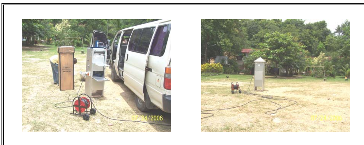
รูปที่ 6 การเก็บตัวอย่างปริมาณฝุ่นละอองรวม (TSP) บริเวณวัดผาหมูสามัคคีธรรม
