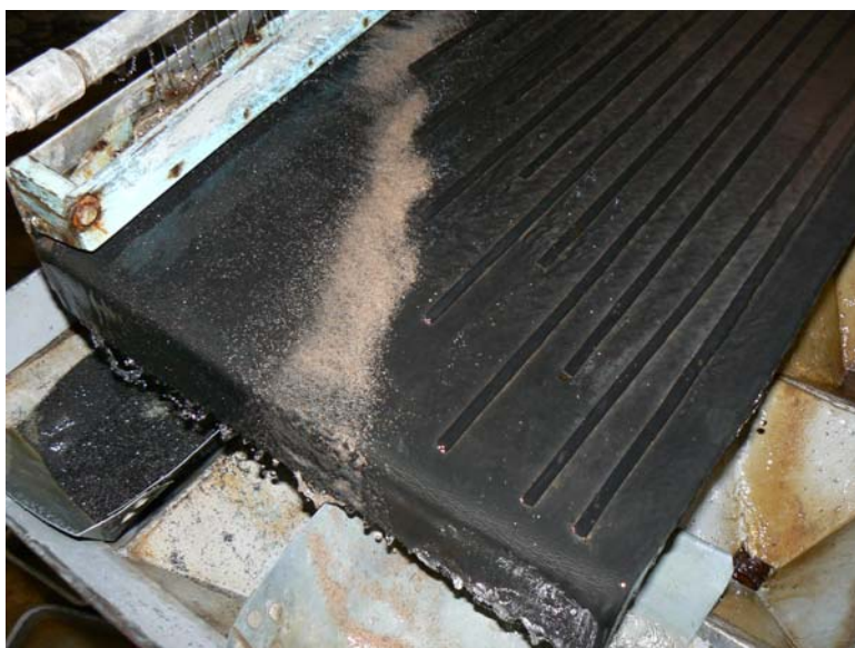
รูปที่ 9 แร่วูลเฟรม (สีดำ) ที่แยกจากสิ่งเจือปน (สีชมพูอ่อน) ด้วยการแต่งแยกแร่ด้วยโต๊ะสั่น
