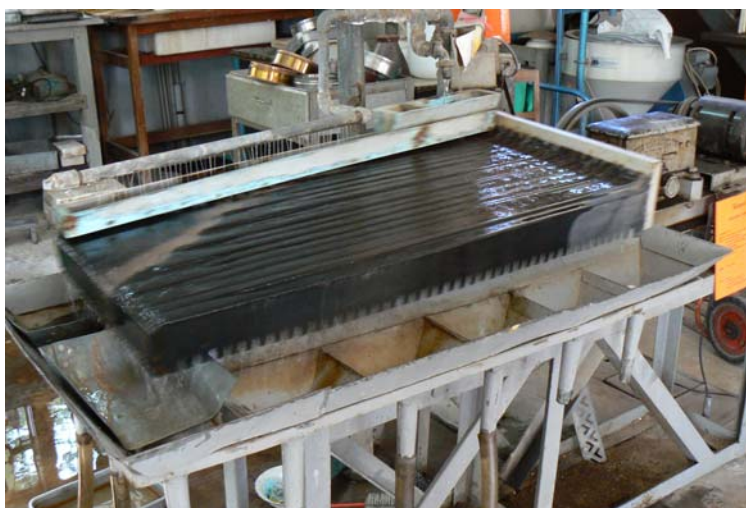
รูปที่ 8 การแต่งแร่ด้วยโต๊ะสั่นแยกแร่
