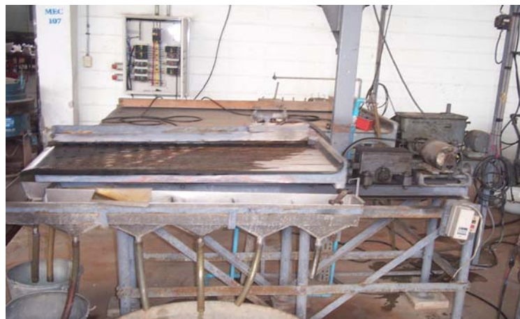
รูป 2.5 ขณะทำการคัดขนาดด้วยโต๊ะแยกแร่
