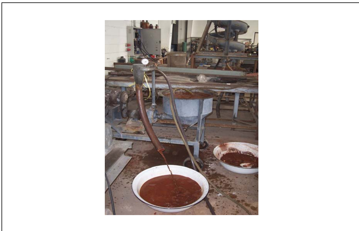
รูป 2.4 ขณะทำการคัดขนาดด้วยไฮโดรไซโคลน
