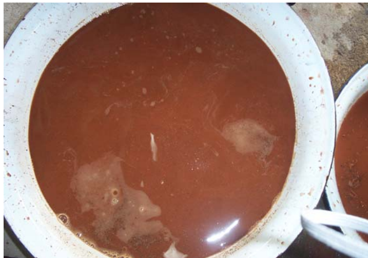
รูป 3.1 ตัวอย่าง Slime เป็นน้ำดินที่ได้จากการล้างแร่ด้วยน้ำ
