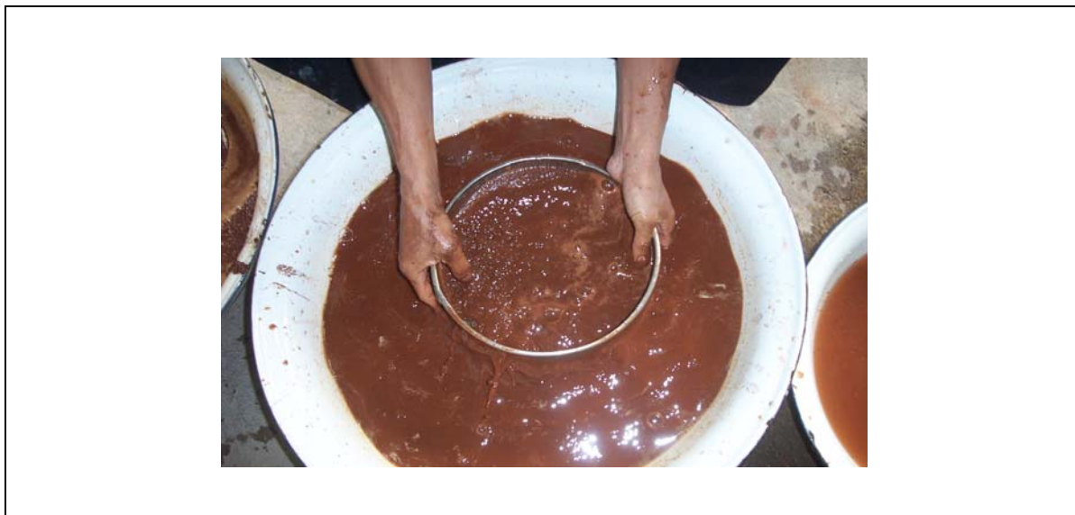
รูป 2.2 นำแร่มาแช่น้ำและกวนทิ้งไว้เพื่อละลายเอาดิน(Slime)ออก ทำการร่อนเปียกด้วยตะแกรงเพื่อคัดเอาเม็ดแร่ขนาด+20mesh
