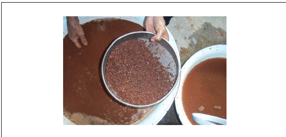
รูป 2.3 เม็ดแร่ขนาด +20 mesh ที่ได้จากการร่อน
