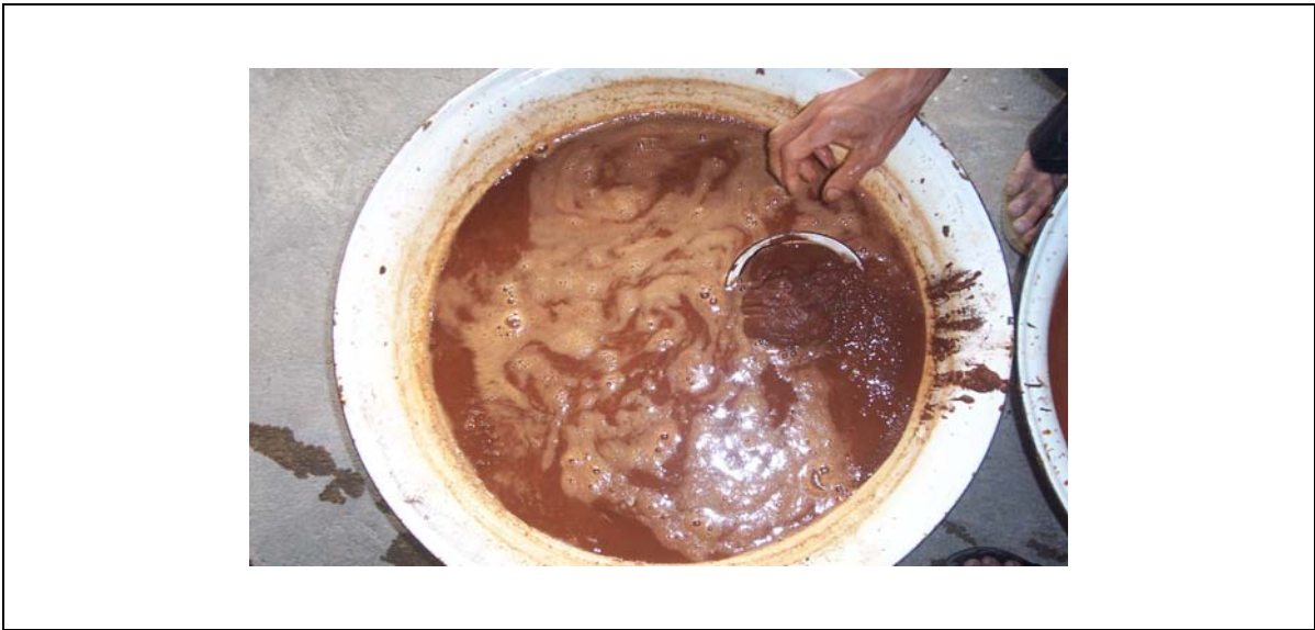
รูป 2.1 นำแร่มาแช่น้ำและกวนทิ้งไว้เพื่อละลายเอาดิน(Slime)ออก
