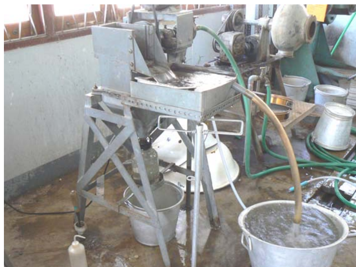
รูปที่ 6 จิกแยกแร่ (Jig) ขณะทำการทดลอง
