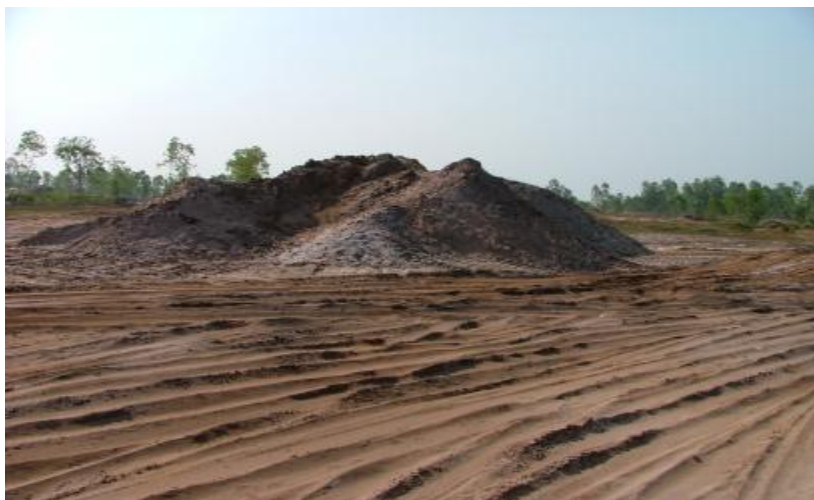
รูปที่ 1 ทรายแก้วจากเหมืองแร่เรียกว่า “ทรายดิบ”
