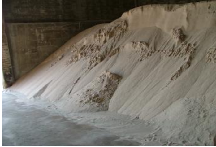
รูปที่ 3 ทรายล้างที่ผ่านการแต่งด้วยเครื่องมือชนิด Spiral เรียกว่า “ทรายแต่ง”
