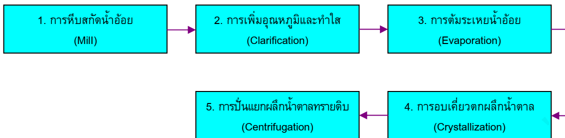
รูปที่ 2 กระบวนการผลิตน้ำตาลทรายดิบ
