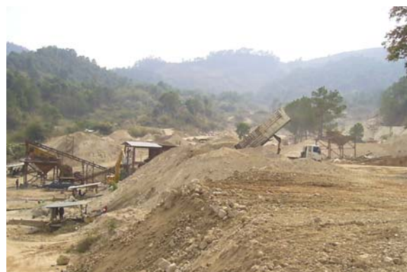
รูปที่ 4 รถบรรทุกดินปนแร่เทกองบริเวณ ส่วนต้นของรางกู่แร่
