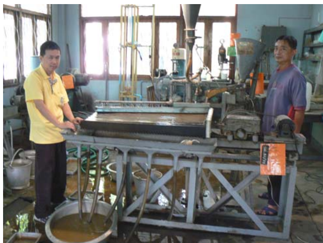
รูปที่ 8 การแต่งแร่ด้วยโต๊ะสั่น
