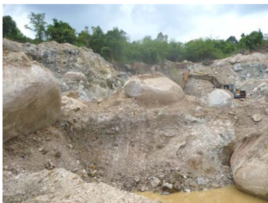
รูปที่ 3 การขุดคอกแร่ที่ประในเนื้อดินปนหินผุ
