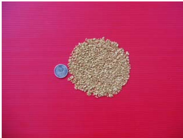
รูปที่ 10 โลหะทองคำที่ได้จากการรีดักชันด้วยกรดออกซาลิก
