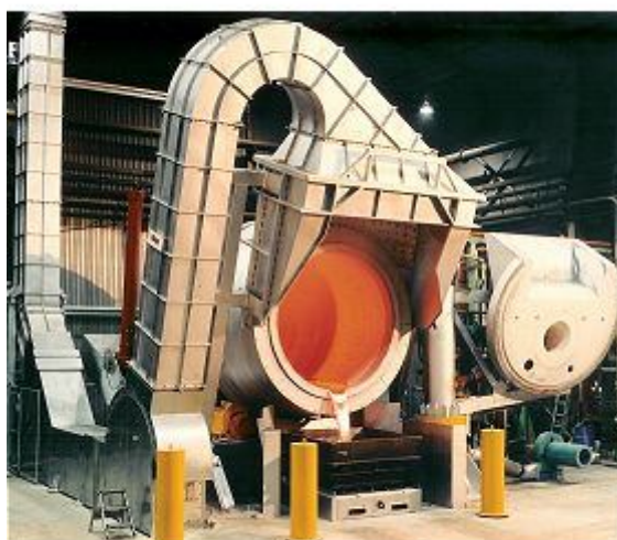
รูปที่ 4.4 เตาหมุนสั้น (Short Rotary Furnace) (ที่มา: www.majoreng.com.au )
