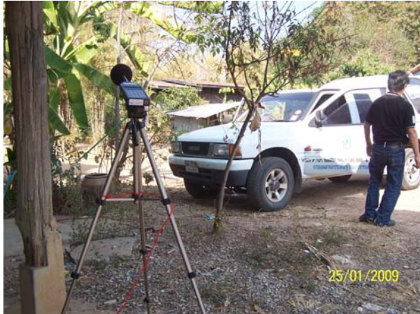
รูปที่ 5 แสดงการตรวจวัดระดับเสียงที่สถานีบ้านหนองระมาน
