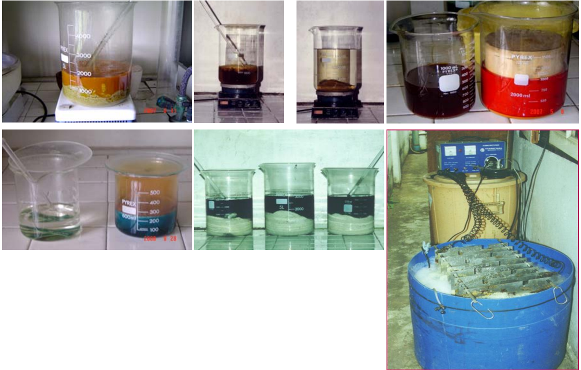
รูปที่ 2.5 การแยกสกัดโลหะด้วยเทคโนโลยีโลหะวิทยาสารละลายหรือโลหะวิทยาเคมี
