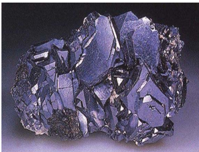
แผนภาพที่ 4.1 แร่ตะกั่วซัลไฟด์ ( PbS ) หรือแร่กาลีนา
