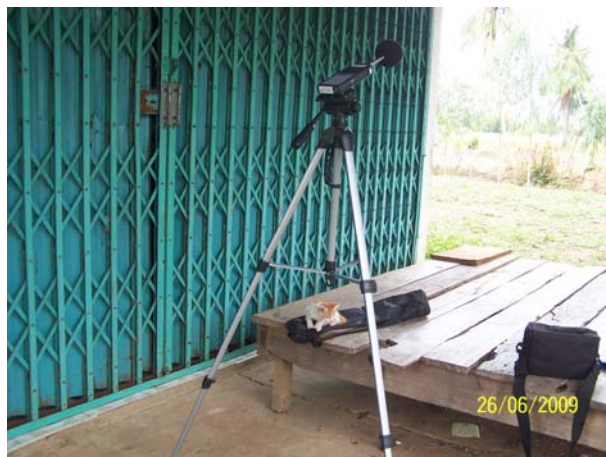
รูปที่ 6 แสดงการตรวจวัดระดับเสียงที่สถานีบ้านหนองแสง
