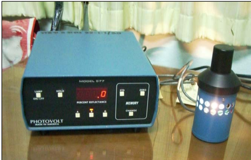
รูปที่ 4 Photovolt ใช้ในการวัดค่าความขาวสว่าง
