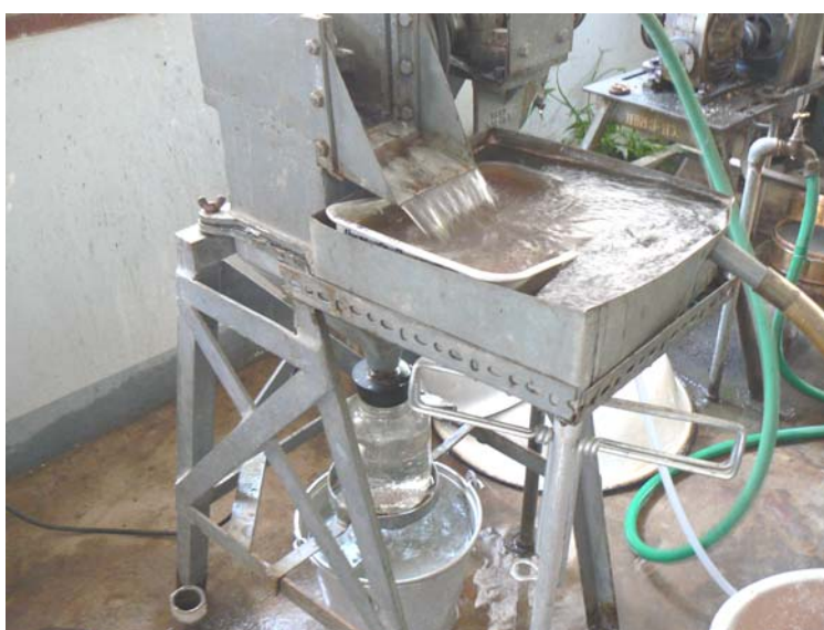
รูปที่ 5 ภาพขณะกำลังทำการทดลองแต่งแร่แบไรต์ด้วยจิ๊ก
