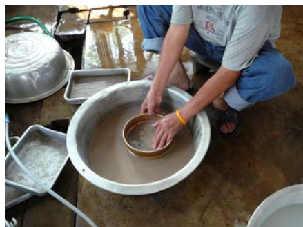
รูปที่ 6 การคัดขนาดตะกอนด้วยตะแกรงมาตรฐาน
