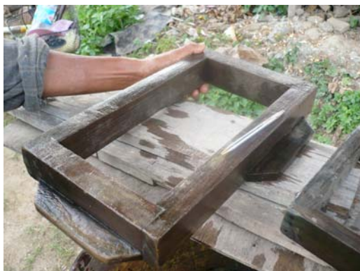
รูปที่ 10 แม่แบบสำหรับขึ้นรูปอิฐขนาดใหญ่
