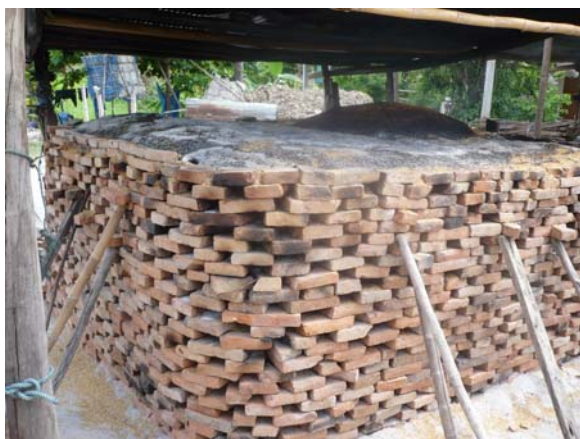
รูปที่ 17 กำลังเผาอิฐเป็นวันที่สอง
