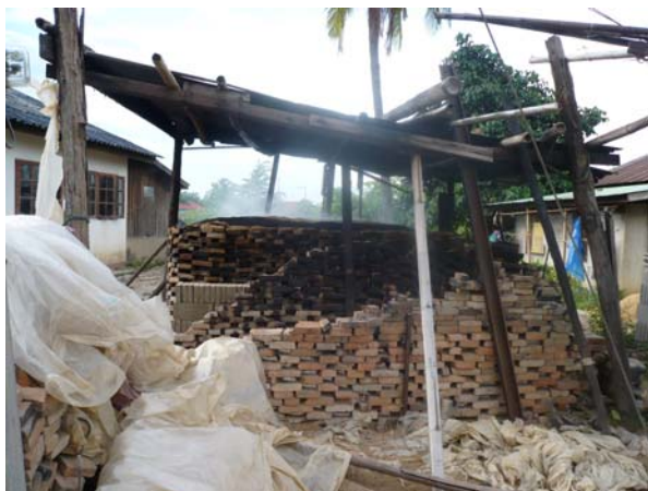
รูปที่ 12 ทำการเผาโดยใช้แกลบเป็นเชื้อเพลิง
