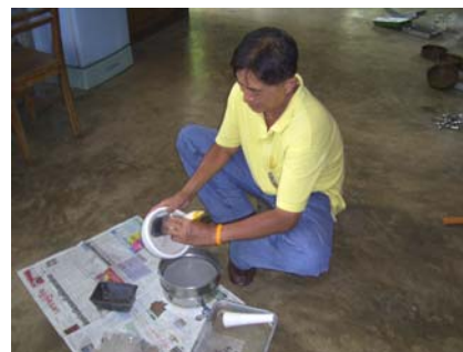
รูปที่ 7 การบดตัวอย่างก่อนการอัดแผ่น
