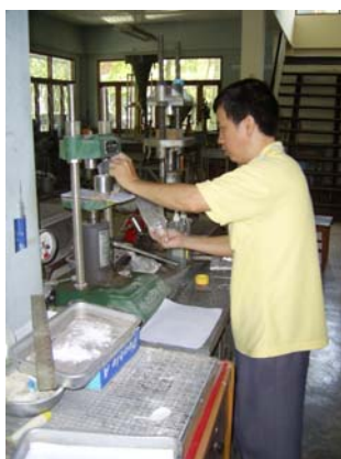
รูปที่ 8 การอัดตัวอย่างด้วยเครื่องอัดไฮดรอลิกส์
